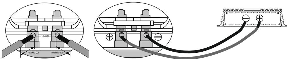
Полное сопротивление =  $\Omega_{Sub 1} + \Omega_{Sub 2} + \Omega_{Sub 3} \dots$
